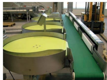
Drehteller zur produktschonenden Sortierung z.B. von Bananen
